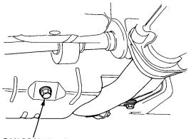
OIL PAN DRAIN PLUG 45 N·m (4.5 kg-m, 33 lb-ft)
